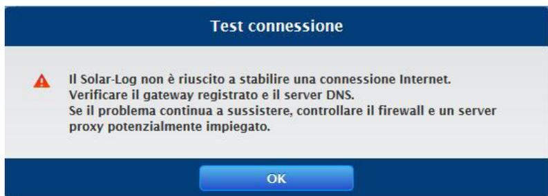
Fig.: Esempio - test di connessione non riuscito
